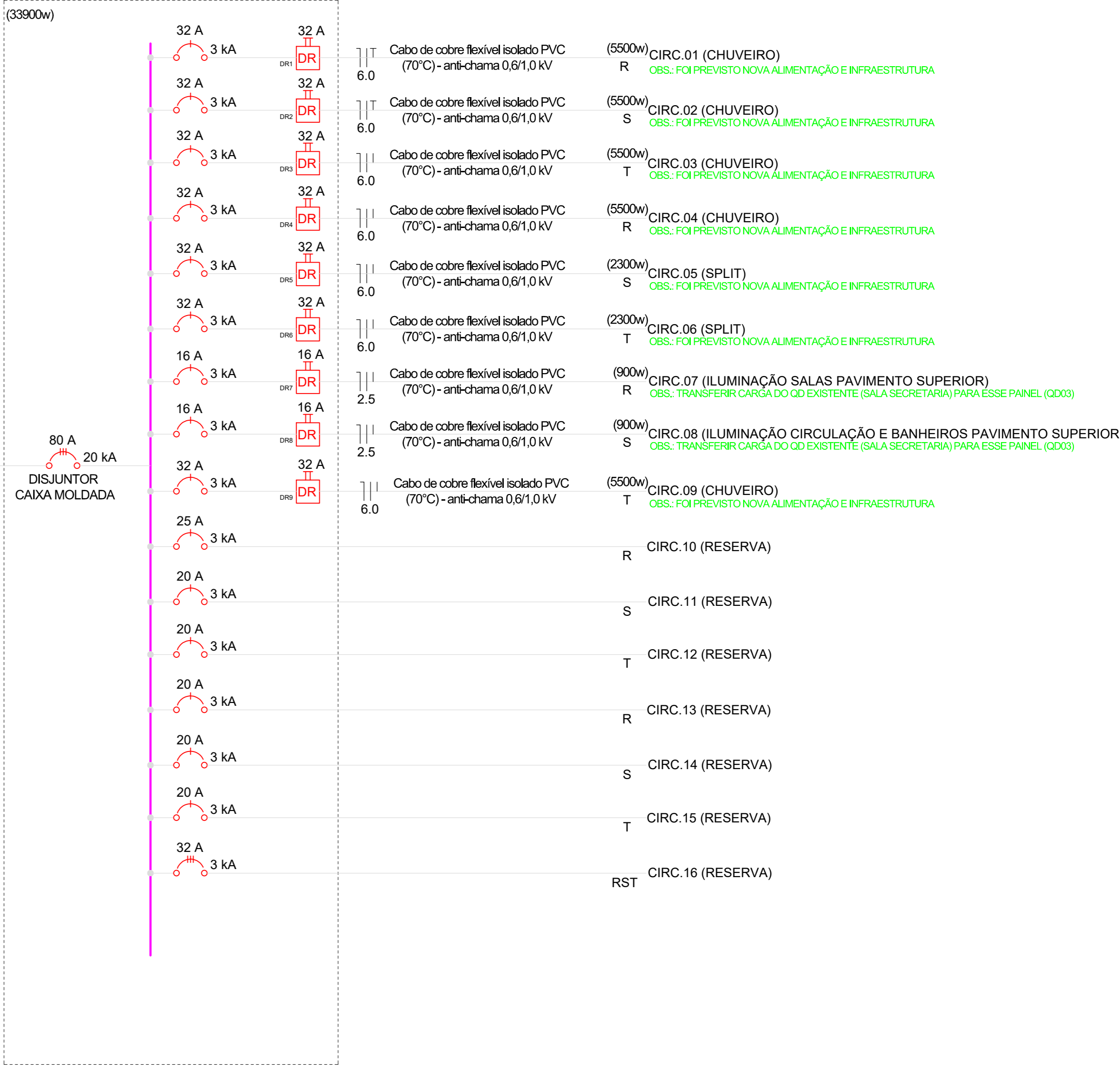
DIAGRAMA UNIFILAR - SITUAÇÃO A INSTALAR QD-03
